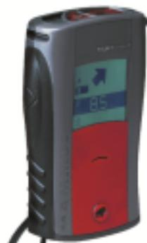
Certains appareils proposent également une fonction « scan » qui permet de visualiser la place des différentes victimes et donne une idée des distances (sous forme de pictogramme signal fort ou signal faible).
