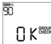
Chaque fois qu'il est enclenché, l'appareil effectue un test de contrôle automatique. Si l'autotest échoue, un message d'erreur est affiché pendant 20 secondes et vous êtes averti par un signal acoustique.
